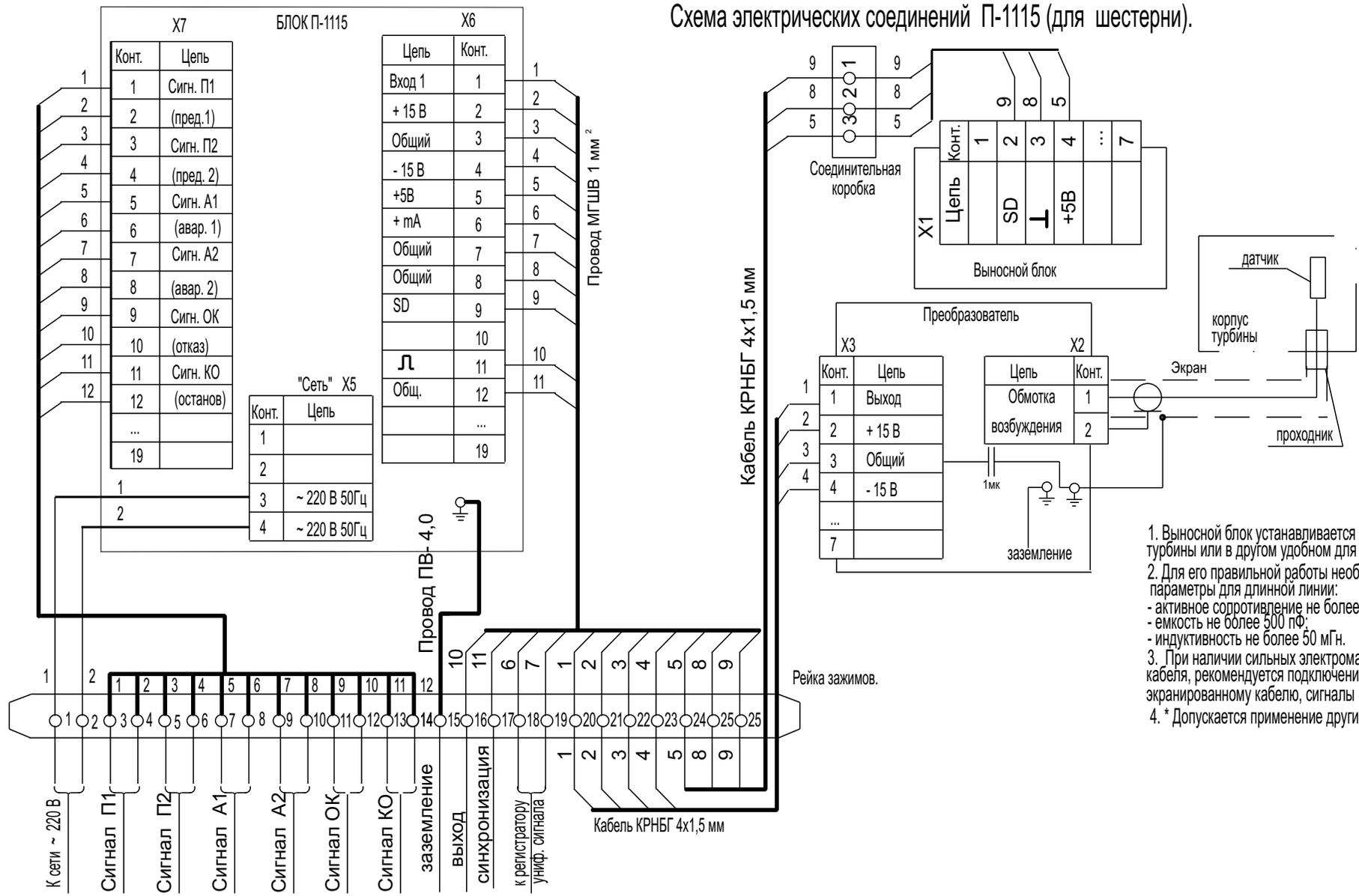
1. Выносной блок устанавливается на переднем стуле корпуса турбины или в другом удобном для эксплуатации месте.
