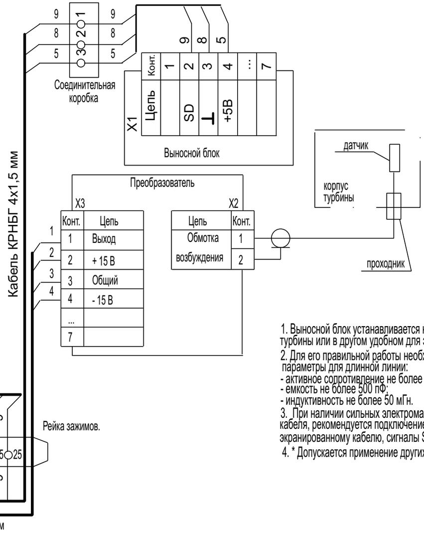
1. Выносной блок устанавливается на переднем стуле корпуса турбины или в другом удобном для эксплуатации месте.
